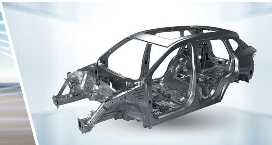
Carrocería compuesta en más del 74% por acero de alta resistencia
